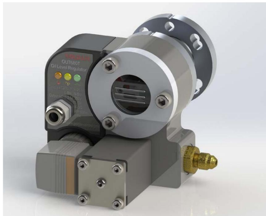
OUT680T 监视并控制制冷压缩机的曲轴箱润滑油油位，由于从共用的储油器采用主动油位调节供油，解决了多压缩机并联时的油分配问题。此油位调节器能保持油位在油视镜的 40%~60%之间。
