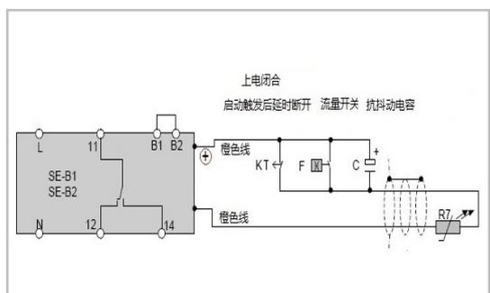
流量开关控制应用事例 图二
