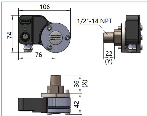
OUT360-T1/T2 液位监视器是专为低压循环桶使用的液位控制器, 利用摆臂原理监测液位, 把实际的液位通过高精度霍尔传感器反馈给微处理器, 运算后控制继电器干接点输出。
