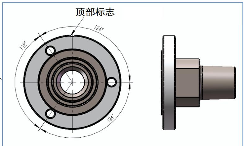
**1/2" -14 NPT 圆锥管螺纹适配器**
