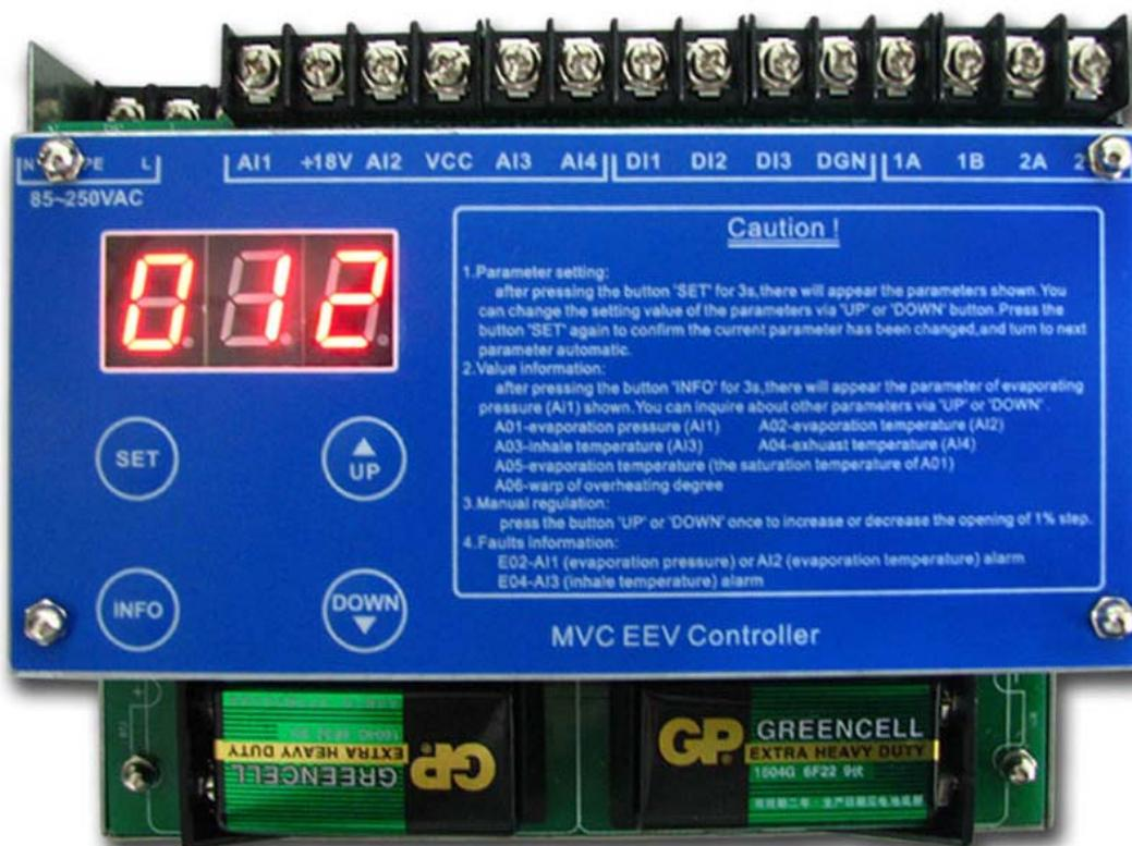
MVC 电子膨胀阀控制器是集成了数据采集、逻辑运算、限流驱动为一体的控制器。该控制器与电子膨胀阀配套使用，能根据环境负荷的动态变化自动调整阀的开度，使冷冻系统达到最佳运行状态。此控制器控制过热度达到 0.5℃的精度，具有按键手动操作功能，数码管显示阀开度，通过设定不同的参数以满足各种冷媒、机型的使用要求。
